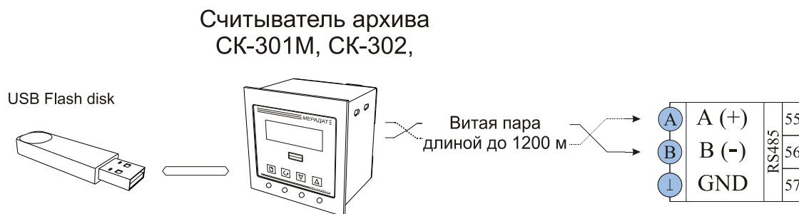
Рис 5.4 Типовая схема подключения прибора к считывателям архива.
