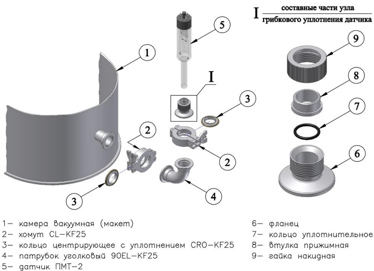
Схема подключения датчика ПМТ-2 к вакуумной системе в разборе
