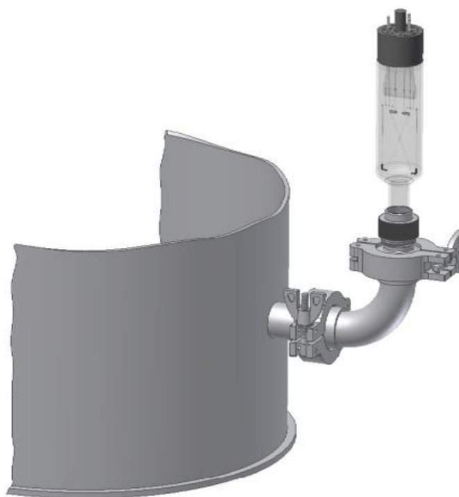
Схема подключения датчика ПМТ-2 к вакуумной системе
