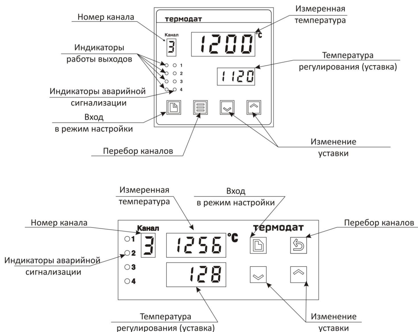
Рисунок 2 – Описание индикаторов и кнопок управления приборов
