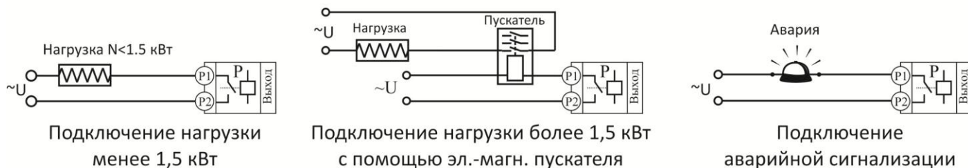
Рисунок 8 – Подключение к релейному выходу
