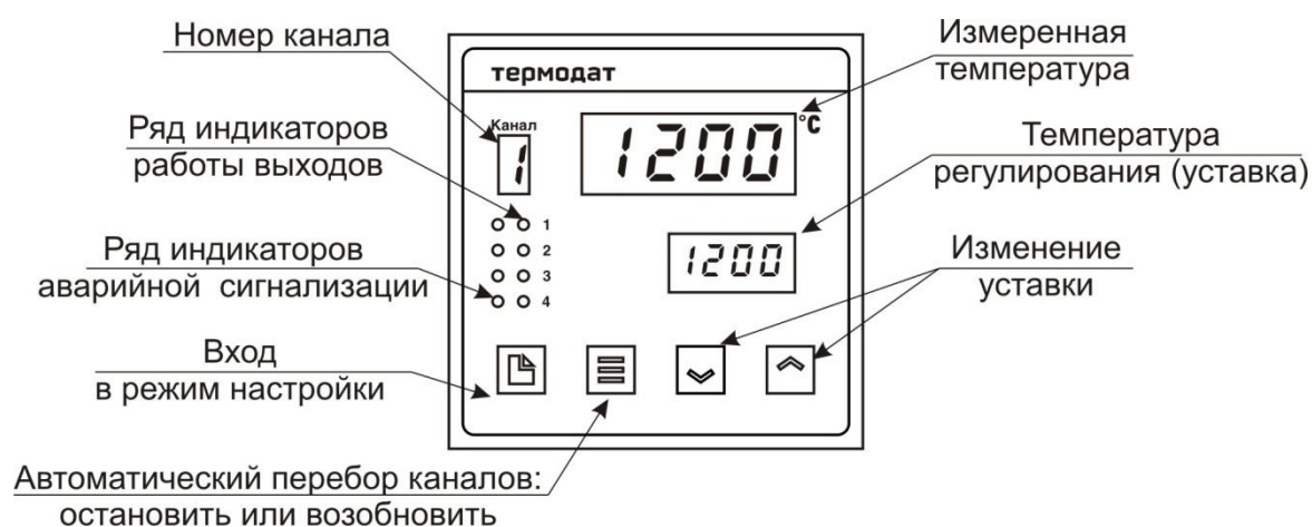
Рисунок 2 – Описание индикаторов и кнопок управления прибора
