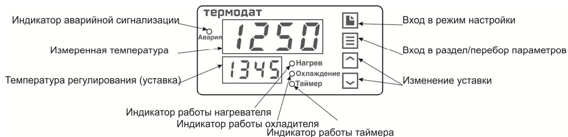
Рисунок 6 – Описание индикаторов и кнопок управления прибора 12К6-D8-H/...
