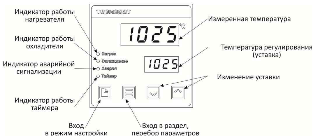
Рисунок 4 – Описание индикаторов и кнопок управления прибора 12К6-D4/...
